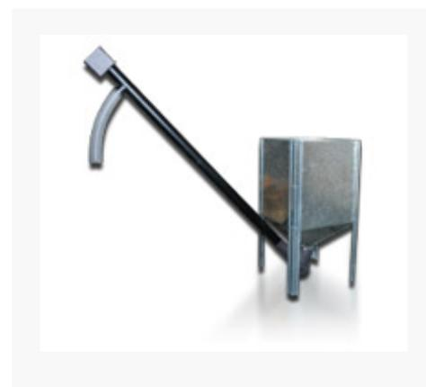
Вспомогательный бункер вместимостью 300 л для прям подсоединения к печи. Этот бункер увеличивает вр автономной работы печи, т.к. для него нужна только одна загруза затем сам бункер с помощью червячного вала подает пеллет печь. Имеет систему безопасности – когда уровень пеллет внешнем бункере опускается ниже минимума, бун останавливается. Прилагается подающий шнек для пел длиной 2 метров.
