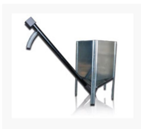
Вспомогательный бункер средней вместимости для прям подсоединения к печи. Этот бункер увеличивает вр автономной работы печи, т.к. для него нужна только одна загруза затем сам бункер с помощью червячного вала подает пеллет печь. Прилагается подающий шнек для пеллет длиной 2 метров
